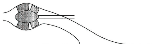
图 3 喷水推进器的典型构型
