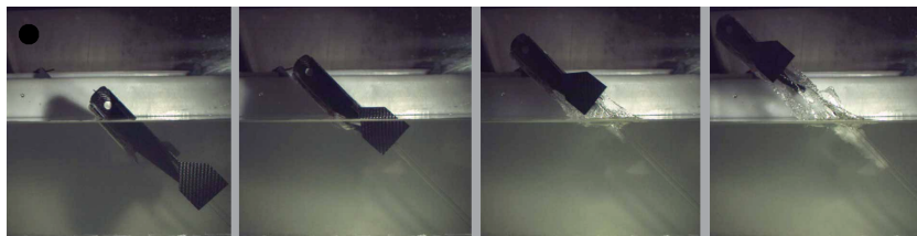
(a) 基于间歇喷水推进的快速跨介质过程
